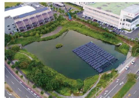
聚恆累積近 20 年經驗，建置約 500 多案，並在 2017 年 10 月獲得德國萊因 (TUV) 的運轉維護 (O&M) 證書，這是全台第一家獲得這項證書的公司。水面型太陽能光電系統與一般常見的屋頂型及地面型光電系統相比，具有多項優點。首先，不佔用土地資源。其次，利用水氣降低太陽能面板的溫度來提升模組的發電效率可達 11%。第三，浮動平台可減少水氣蒸發及抑制藻類生長來維護水池生態。
